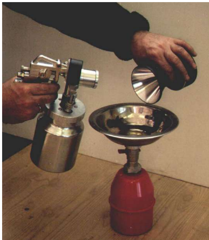
Рисунок 6 - Мойка внутренней поверхности воронки датчика
