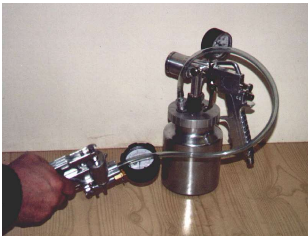
Рисунок 4 - Наддув бака с растворителем от ручного насоса
